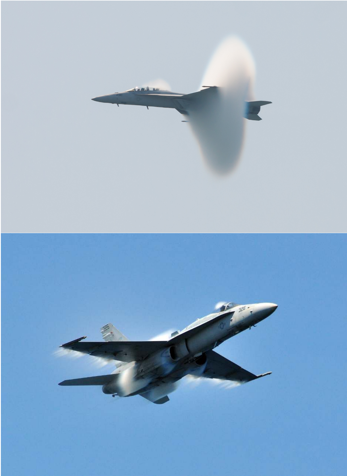
Figura 1.6 – A onda de choque ocorre devido à aceleração do escoamento ao longo da superfície aerodinâmica. fonte: a) < https://www.christography.com/aviation >
