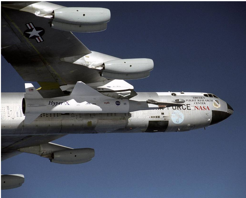
Figura 1.25 – A terceira aeronave de pesquisa hipersônica X-43A, com um foguete Pegasus, levada para lançamento por um B-52B do centro de pesquisa Dryden Flight Research Center em 16 de Novembro de 2004. A aeronave X-43A atingiu a velocidade desejada de Mach 10. Fonte: < https://www.nasa.gov/centers/dryden/multimedia/imagegallery/X-43A/EC04-0325-23.html >
