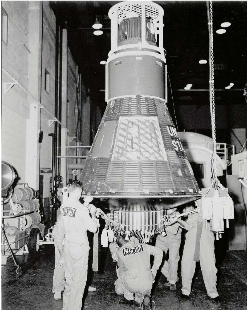
Figura 8.2 – Preparação no Hangar S em Cabo Canaveral, Flórida, da cápsula Wally Schirra Mercury 8, apelidada de Sigma 7 para ser acoplada ao veículo de lançamento Atlas. Imagem S62-05141, de 10/09/1962. Fonte: https://www.flickr.com/photos/nasacommons/15865062483/ (27/04/2020)
